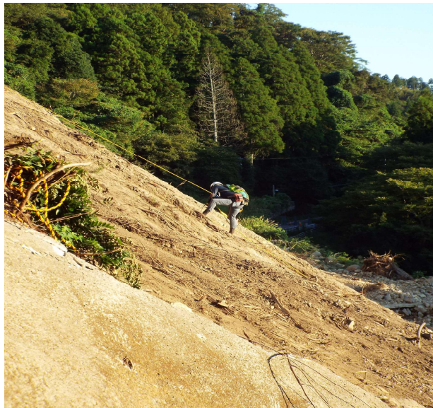
弾性波探査状況
